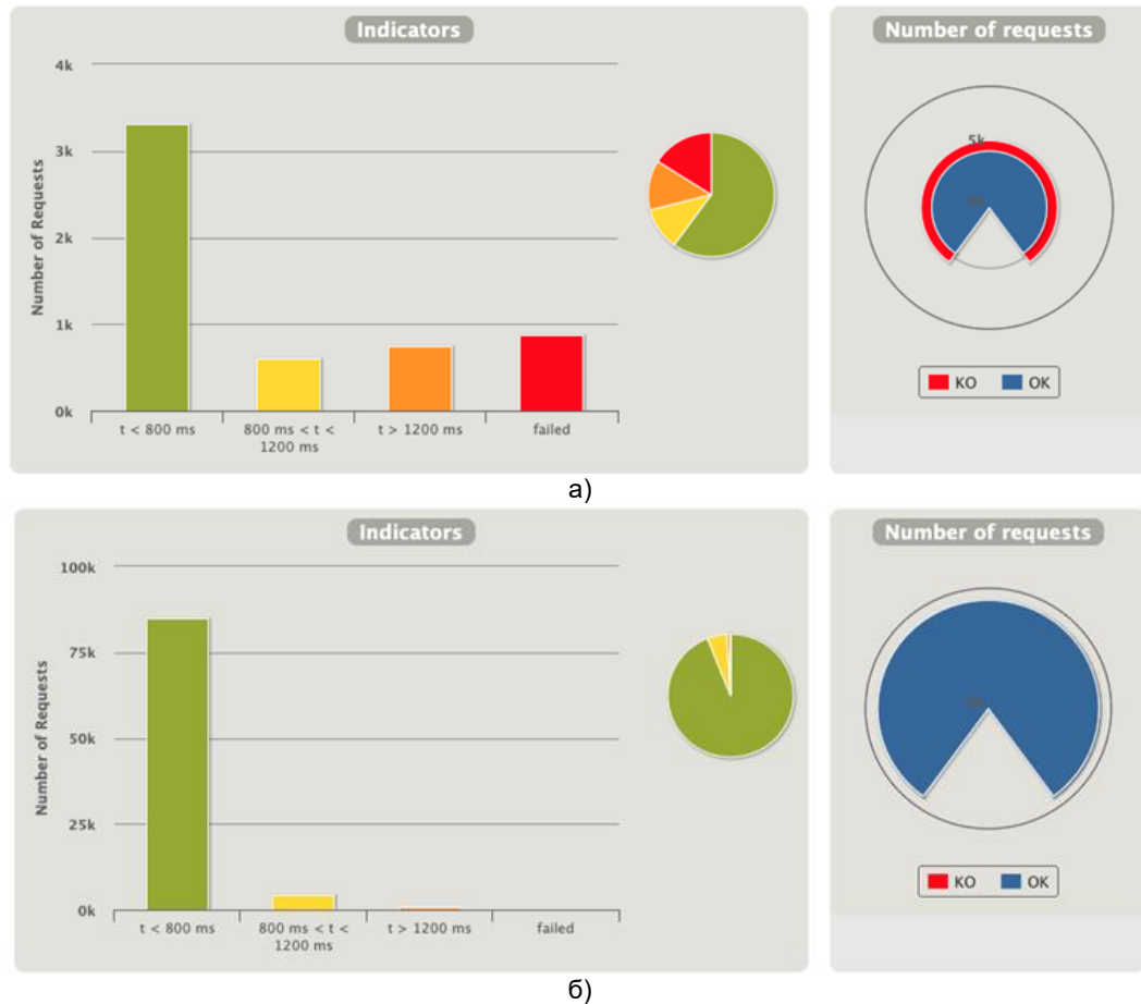
Рис. 3. Діаграми розподілу часу відповіді на запит для а) ECS та б) EKS. Fig. 3. Response time distribution diagrams for (a) ECS and (b) EKS.
