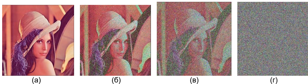
Рис. 2. Початкове досліджуване зображення (а) і приклади зображень із ґаусовим шумом, додатково накладеним на зображення на панелі (а): робочий параметр шуму noise (див. пояснення в тексті) складає 3,86 \cdot 10^{-3} (б), 0,974 (в) і 60,3 (г).
