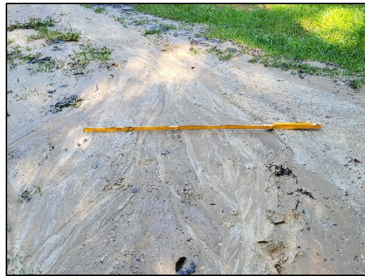
Рис. 2. Конус винесення, який формується навпроти ерозійної вимоїни, зображеної на рис. 1 Fig. 2. The cone of deposition, which is formed
