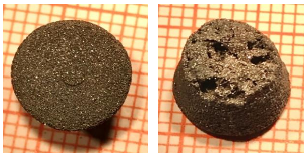
Рис. 2. Зразок \text{Ti}_{50}\text{Si}_{25}\text{C}_{25} після центрифугування Fig. 2. The sample \text{Ti}_{50}\text{Si}_{25}\text{C}_{25} after centrifugation
