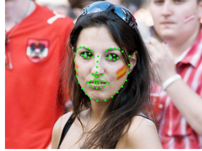
Рис. 4. Виявлення ключових точок обличчя Facial keypoint detection
