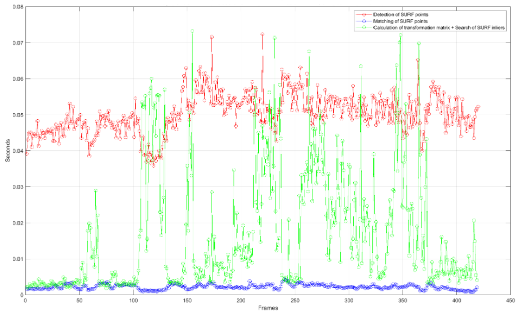
Рис. 8. Час виконання кожного етапу методу SURF з використанням кластерного методу RANSAC при обчисленні траєкторії
