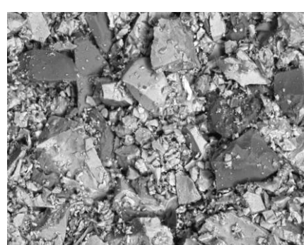
Рис. 5. Особенности флокулирования пироксена и граната с титаномагнетитом в классах различной крупности титаномагнетитовых концентратов (Гусевогорское месторождение, Урал): темно-серый – клинопироксен; белый и серый – титаномагнетит (изображение в упругоотраженных электронах). Сканирующий ЭМ JSM-6400, аналитик В.Н.Филиппов (Сыктывкар).
