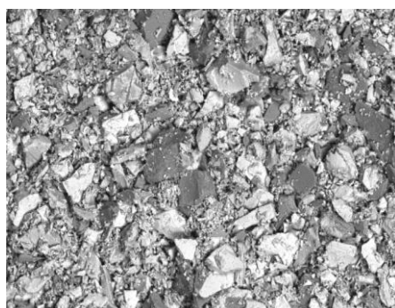
Рис. 5. Особенности флокулирования пироксена и граната с титаномагнетитом в классах различной крупности титаномагнетитовых концентратов (Гусевогорское месторождение, Урал): темно-серый – клинопироксен; белый и серый – титаномагнетит (изображение в упругоотраженных электронах). Сканирующий ЭМ JSM-6400, аналитик В.Н.Филиппов (Сыктывкар).
