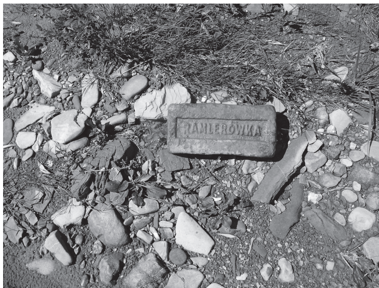
Рис. 1. Розтріскана цегла сучасного виробництва порівняно з “Ramblerówka”, яка має ознаки повної збереженості й часткової обкатаності в русловому алювії р. Лючка (с. Стопчатів).
