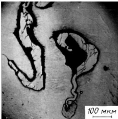
Рис. 4. Зерно шрейберзита в камасите, разбитое трещинами (метеорит Каали; глубокое травление 10%-ным ниталом, под электронным микроскопом)
