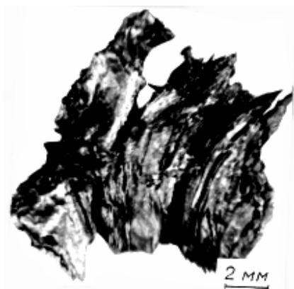
Рис. 1. Пластинчатое строение осколочного образца метеорита Каали (под биноклем)
