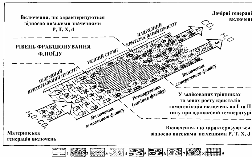
Рис. 11. Схематизована ілюстрація формування генетично споріднених генерацій включень (материнської та дочірніх) відповідно, із флюїдів материнської та дочірніх порцій. Стрілками показаний напрям руху мінералотворних флюїдів, у межах флюїдного потоку і зазначені материнська (1) та дочірні (2, 3) порції флюїдів.
