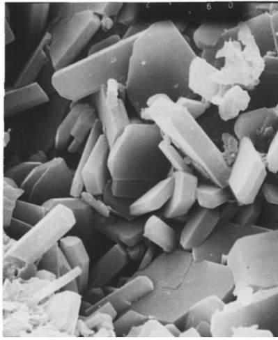
Рис. 2. Невпорядковане заповнювання кристалами кліноптилоліту пор у вулканічному туфі. Крайникове. Стереоскан. 3 000 \times .
