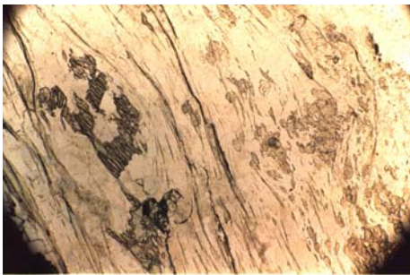
Рис. 2. Мікрофотографія дистен-андалузит-мусковітового кварциту. КНГС, зразок 10203, гл. 2293–2299 м. Ліворуч – скелетні порфіробласти дистену (з високим рельєфом). Праворуч – ізометричні порфіробласти андалузиту з нижчим рельєфом та невеликими вторинними вкрапленнями діаспору (з великим рельєфом). Порфіробласти дистену й андалузиту облямовані субпаралельно орієнтованими пластинчастими кристалами мусковіту. Без аналізатора, 30 × .
