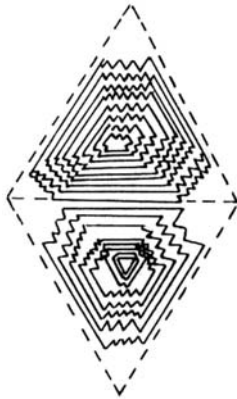
Рис. 2. Схема утворення гексаедричного кристала, складеного тригональними шарами, де формою росту є октаедр.
