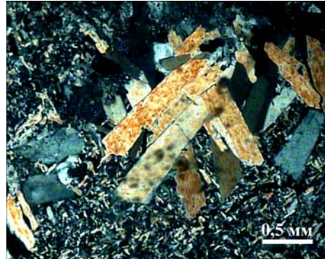
Рис. 2. Збірна перекристалізація структури розкристалізації гелю кремнезему. Ніколи \times .
