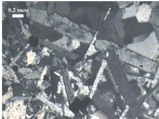
Рис. 7. Каркасна текстура дрібнозернистого агрегату бариту з трьома осьовими напрямками орієнтації бариту (рудне тіло XIX). Ніколі \times .
