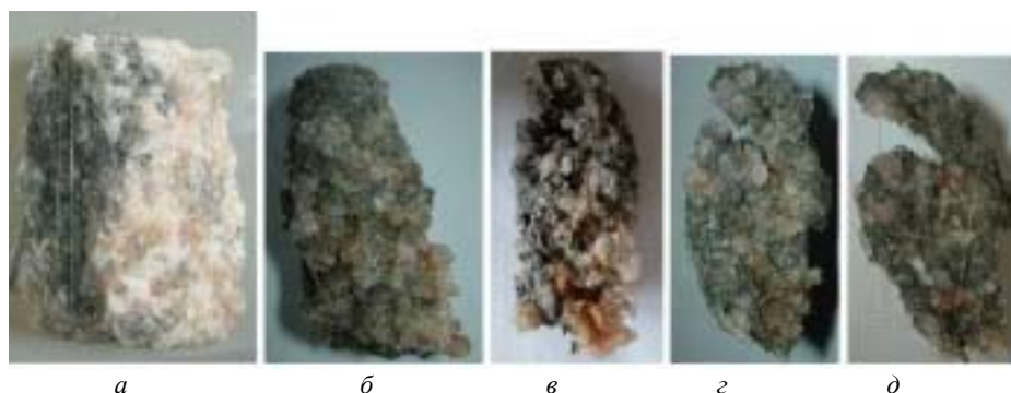
Рис. 12. Кінетика розчинення каїнітової руди (взірець 12): а – до початку експерименту; б – через дві години розчинення в агресивному розсолі; в – через три доби; г – через тиждень; д – через три тижні.
