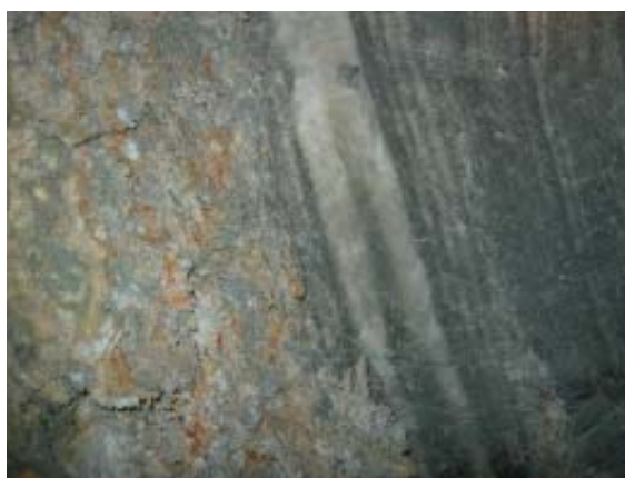
Рис. 3. Контакт каїніт-лангбейнітової руди (ліворуч) з “пісковиком” (праворуч). Стінка камери на вентиляційному горизонті рудника № 2.
