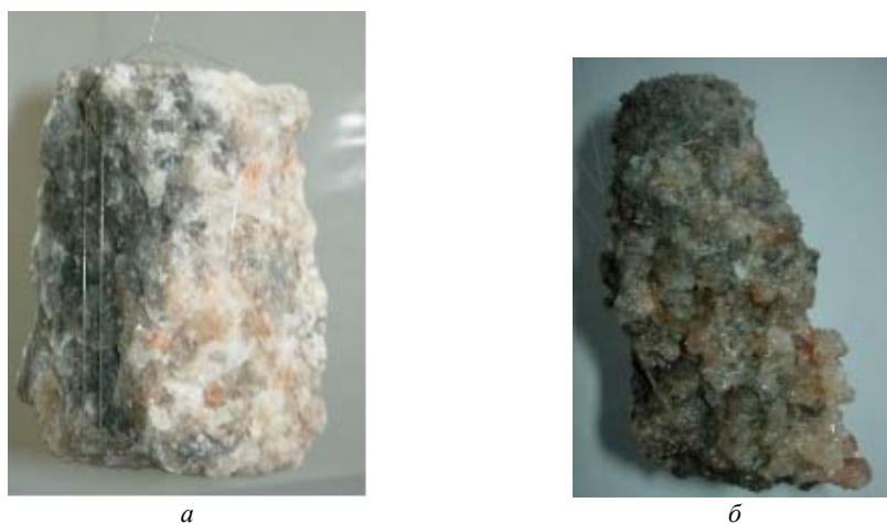
Рис. 5. Взірець 12: a – до початку експерименту; б – після перших двох годин розчинення в агресивному розсолі.
