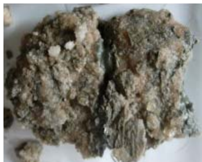
Рис. 9. Розчинення легкорозчинного прожилку кізериту, яке призводить до дезінтеграції каїніт-лангбейнітової руди.
