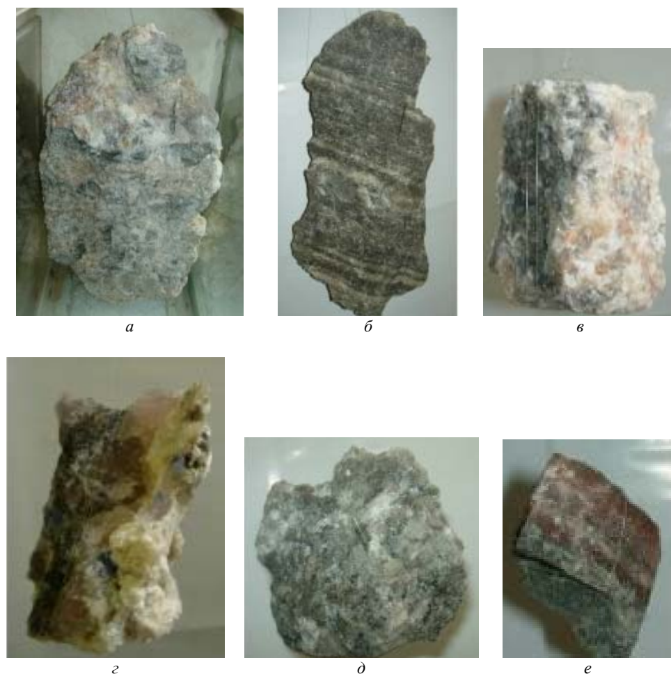
Рис. 4. Світлини взірців, які зазнавали розчинення в агресивному розсолі рудника № 2 (у дужках наведено відсотковий вміст мінералу):
