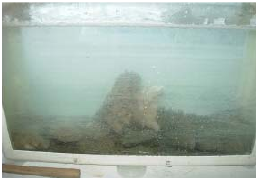
Рис. 7. Вигляд акваріума після трьох діб експерименту: ліворуч – повністю дезінтегрований на дрібні уламки двокілограмовий зрізець каїніт-лангбейнітової руди (зрізець 10); праворуч – інтенсивно розчинений однокілограмовий зрізець “пісковіку” (зрізець 11); у центрі – інтенсивно розчинені інші досліджувані зрізці (12–15).
