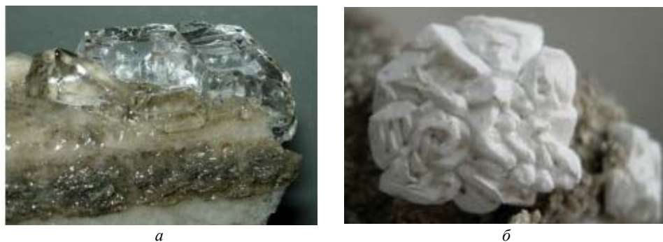
Рис. 10. Друза кристалів мірабіліту на поверхні “пісковіку” (а) і така ж друза, декорована тенардитом (унаслідок збезводнення поверхні мірабіліту) (б).
