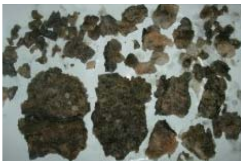
Рис. 8. Великі та дрібні уламки двокілограмового зрізця каїніт-лангбейнітової руди (взірець 10) після трьох діб експерименту.
