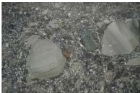
Рис. 1. Неоднорідна брекчієподібна та неявно шарувата текстура порід, що вміщують рудні поклади порід – глини з галітом та уламками теригенних порід пісковиків і алевролітів.
