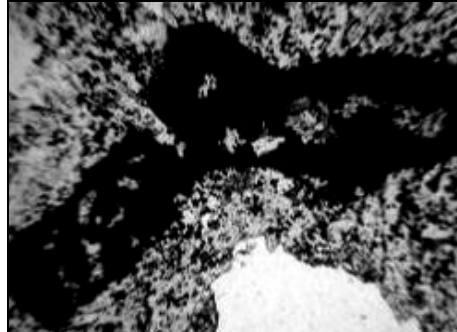
Рис. 9. Порфірові футляроподібні кристали магнетиту (чорне) у зростках з кальцієвим силікатом (ясно-сіре). Прозорий шліф. Ніколі ||. \times 30 .
