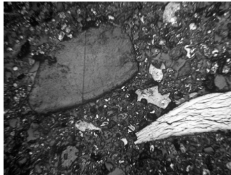
Рис. 6. Співвідношення розмірів нерудних і рудних мінералів та коксового пилу. Полірований шліф. \times 80 .
