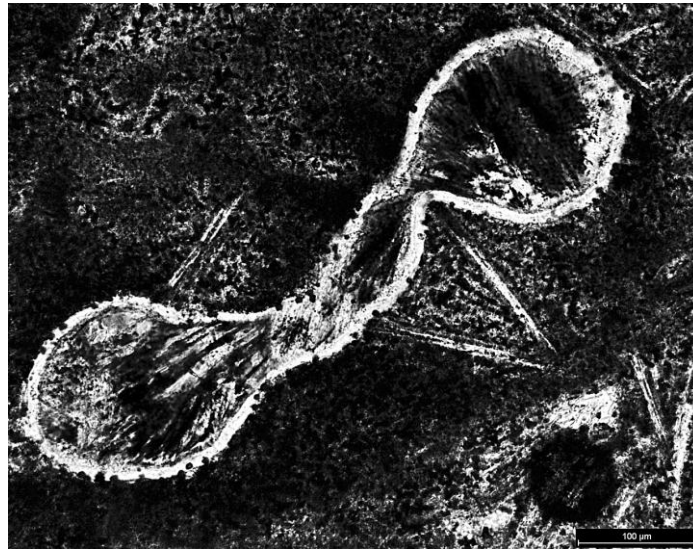
Рис. 5. Перехідний інтервал від зони загартування до зони мандельштейну.
