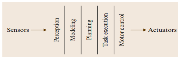
Рис. 1. SPA (sense-plan-act) парадигма – алгоритм роботи машини за принципом вимірювання – планування – дія. Адаптовано із [9].
