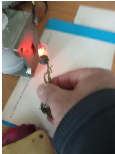
Рис. 1. Світіння неоновієї лампочки демонструє наявність мікрохвильового випромінювання через вихідний фланець стандартного хвильоводу поперечним перерізом 10 \times 23 \text{ мм}^2 .
