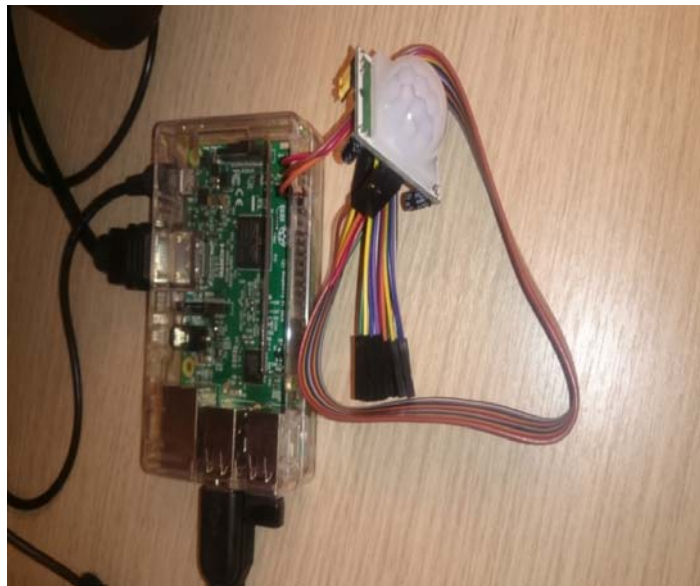
Рис. 8. Підключення датчика руху до Raspberry Pi
