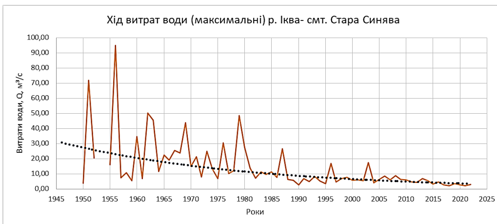
Рис. 6. Графік ходу максимальних витрат води р. Ікви – смт Стара Синява з нанесеною лінією тренду
