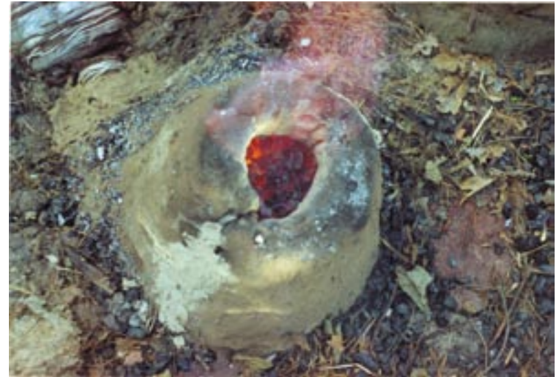
Фото 51. Етап розігріву шихти в горні. Photo 51. Stage of warming of shift in furnace.
