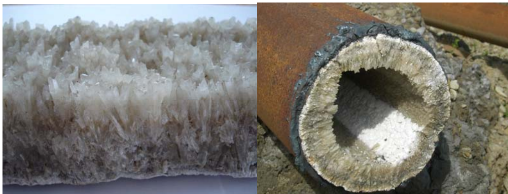
Рис. 4. Друзові агрегати гіпсу на стінках ропопроводу (Домбровський кар'єр, Калуш).
