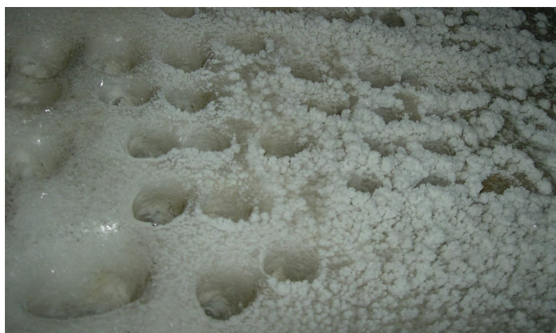
Рис. 11. Комірчасто-сітчаста текстура поверхні солі в межах дренажної галереї шахти № 8, що утворилась внаслідок крапельного вилуговування.
