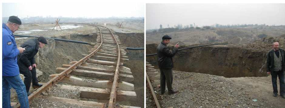
Рис. 14. Карстові провали із субвертикальними стінками у перекривних відкладах у місцях інтенсивного розмивання соляного дзеркала.
