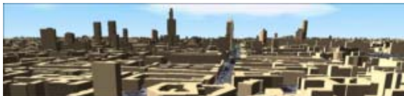
Рис. 6. 3D модель м. Варшава (Польща), виконана за допомогою технології LIDAR.
