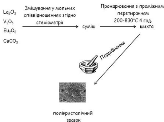
Рис. 1 Схема твердофазного синтезу зразків систем \text{La}_{1-x}\text{Eu}_x\text{VO}_4 та \text{La}_{1-x}\text{Ca}_x\text{VO}_4 ( 0 \leq x \leq 0,5 ).
