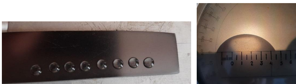
Рис. 1. До визначення крайового кута змочування розчинами графіту марки МПГ-7 Fig. 1. To determine the marginal angle of MPG-7 graphite wetting by solutions
