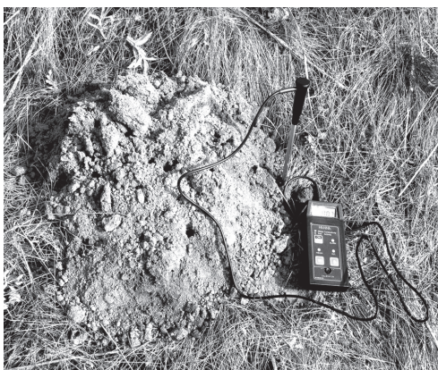
Рис. 2. Портативний прилад HI 993310 зі сенсором HI 76305 (Hanna Instruments, Woodsocket, RI) для вимірювання провідності ґрунту.
