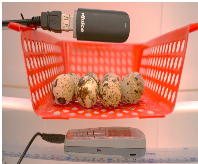
Рис. 1. Опромінення перепелиних ембріонів in ovo (дослідна група) РЧВ за допомогою комерційної моделі мобільного телефона Nokia 3120 та 3G модему з голосовою функцією Huawei e173
