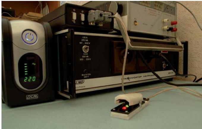
Рис. 1. Трихвильовий датчик для вимірювання відносної концентрації карбоксигемоглобіну.
