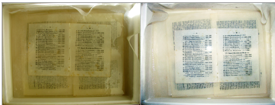
Процес нейтралізації кислотності і видалення лисячих плям.
